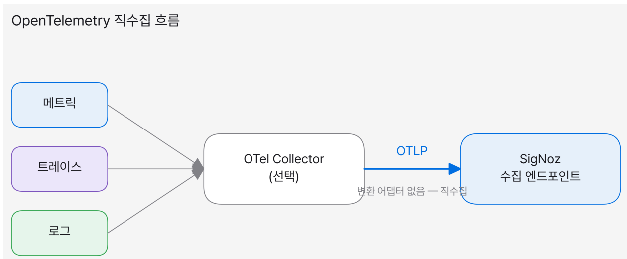
그림. OTEL로 계측한 애플리케이션이 OTLP로 신호를 보내 SigNoz가 직접 수집하기까지의 흐름
